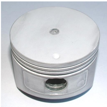
Рисунок 3 – Поршень двигателя Briggs&Stratton модели 115400 восстановленный газодинамическим напылением и упрочненный МДО
